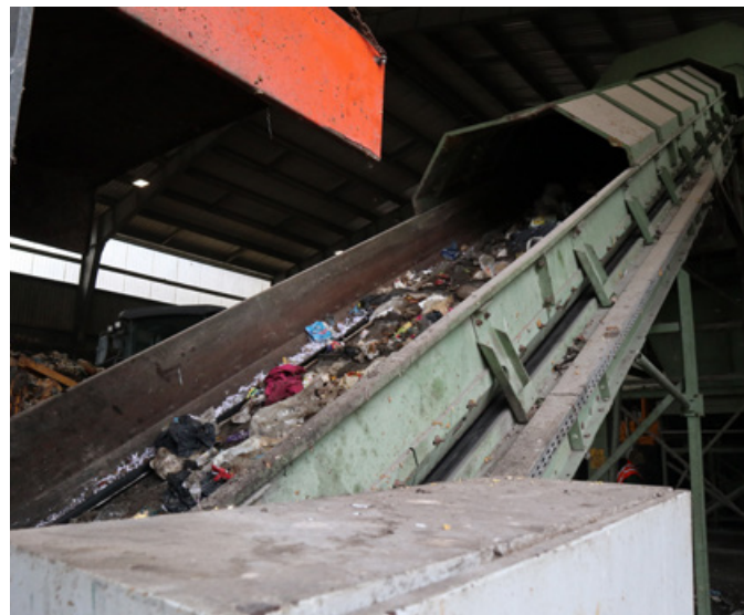
Rozrywarka nie tylko rozcina worki, ale i rozprowadza ich zawartość równomiernie na całej powierzchni przenośnika, ułatwiając ręczne sortowanie.
